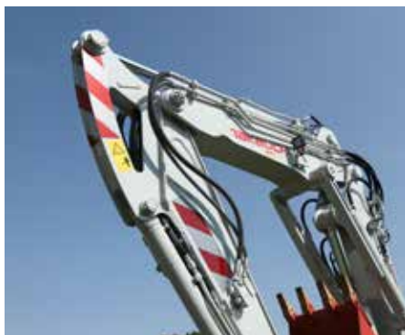
CATARIFRANGENTI BICOLORE SUL BRACCIO
